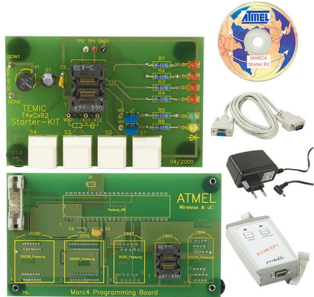
**Fig. 5. Atmel MARC4 Starter Kit**
