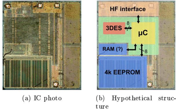
Fig. 3: The DESFire MF3ICD40 IC
